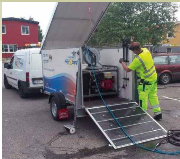
Miljövänlig ogräsbekämpning med hetvatten.
