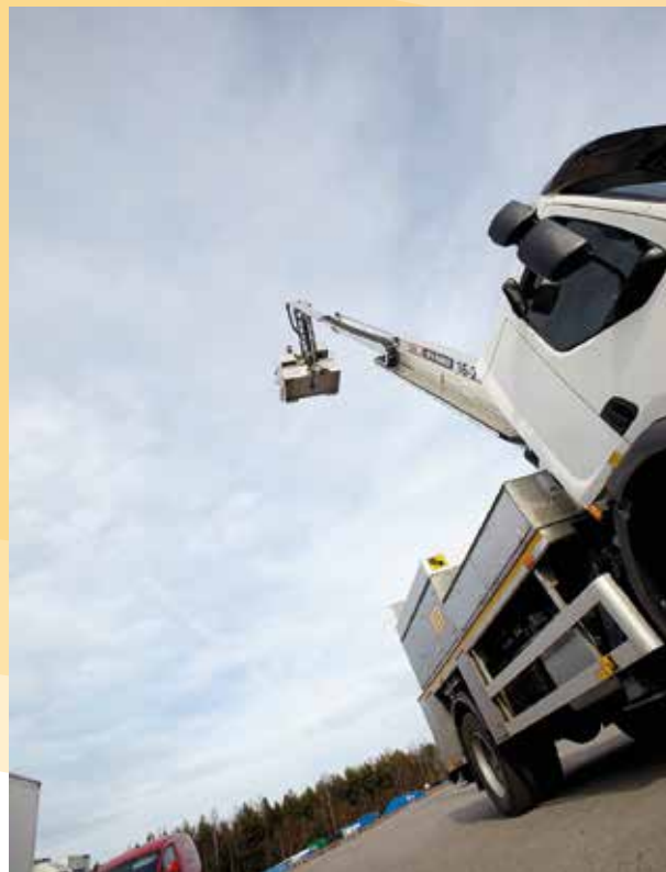
16 meter upp i luften når kranen på den nya gatljusbilen.
