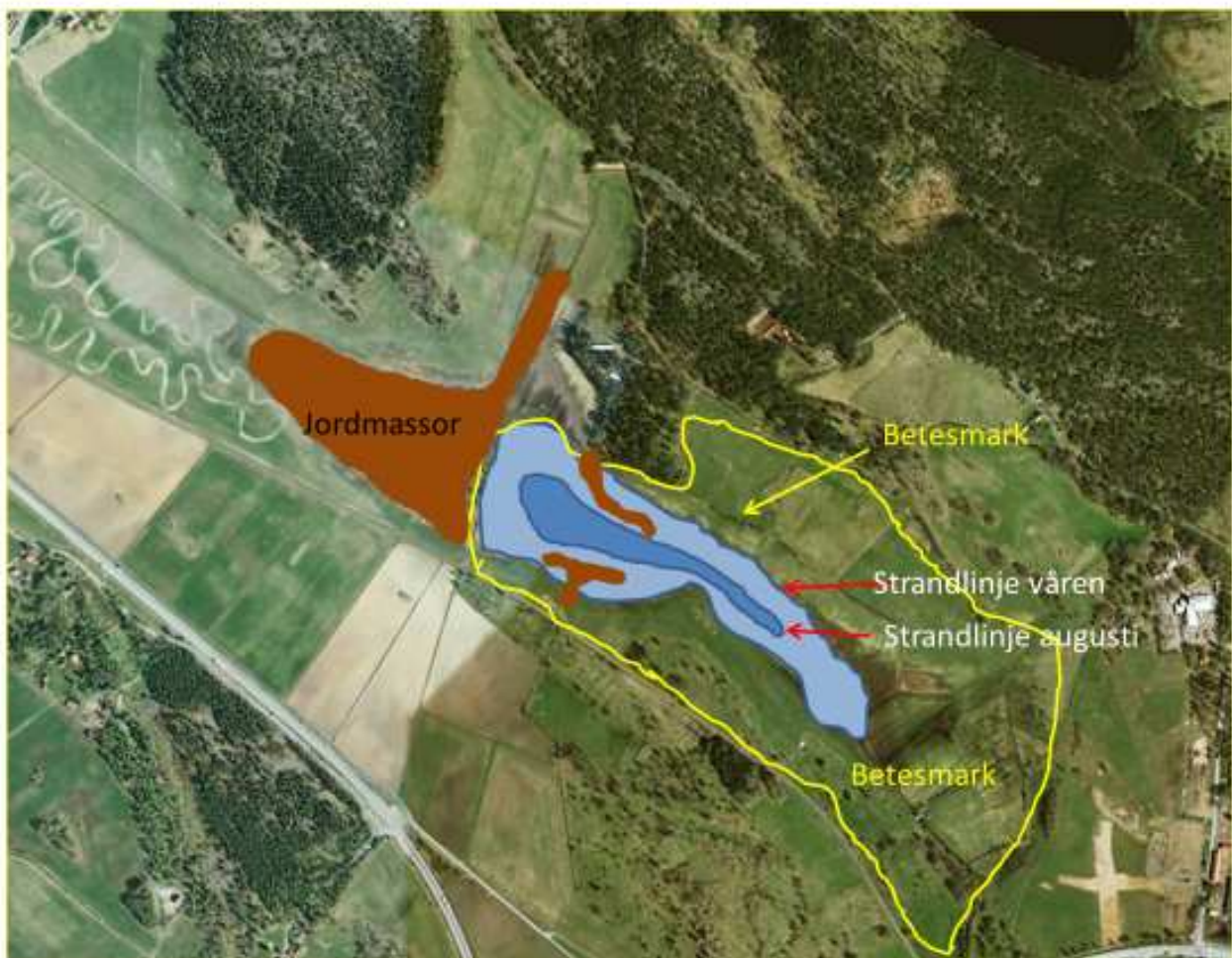
Utformning av projekterad våtmark vid Källsåker
