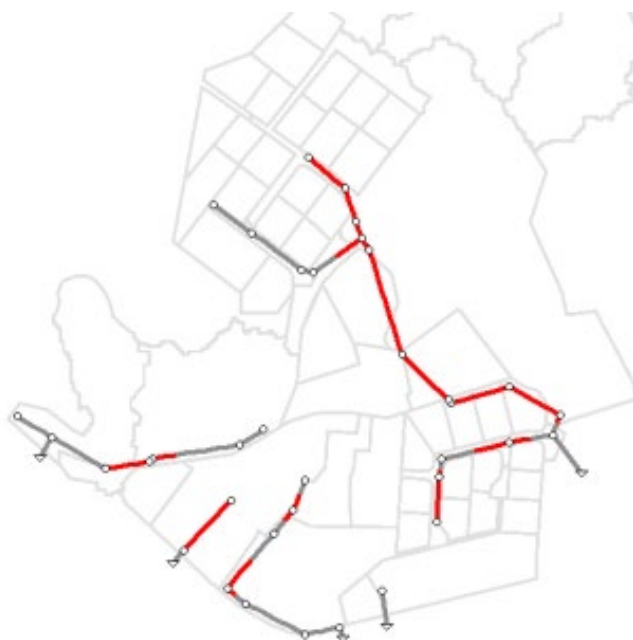
Figur 7. Översiktskarta nyläge dagvattennät med 10-årsregn utan klimattfaktor där färgen röd indikerar marköversvämning (Tyréns, 2020).
