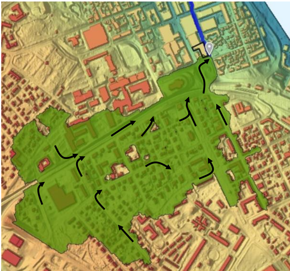
Figur 6. Ytligt avrinningsområde uppströms planområdet. Avrinning kring fastigheten sker från bland annat uppströms kyrka, sjukhus, skola, affärsområde, vårdcentral och bostadsområden. Avrinningen sker kring planområdet via Båtsmansgatan i söder och Brunnsgratan i öst.
