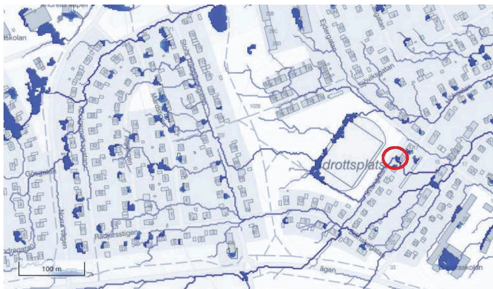
FIGUR 13: Befintlig utjämningsvolym vid fotbollsplanen och mer detaljerade rinnvägar. Fastighet utmed Svangatan som initialt riskerar att drabbas nedströms planområdet är markerad i rött (Dagvattenutredning, Tyréns).
