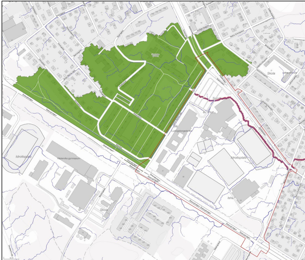
Figur 29. Avrinningsområdet som rinner in mot Bökensved från nordväst är ca 15 ha. Plangränsen visas i rött. Källa: Scalgo Live 2023.
