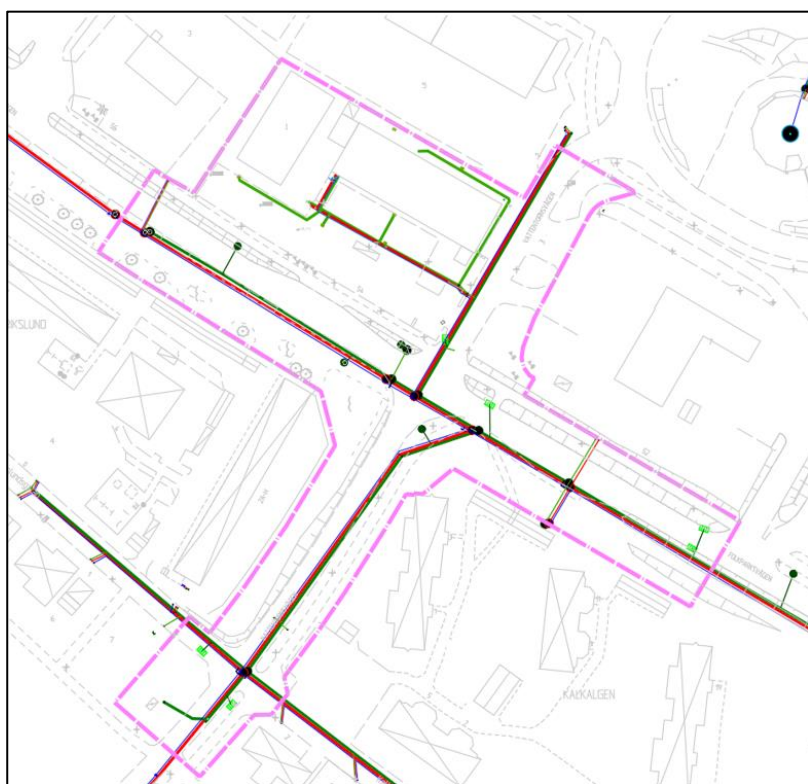
Figur 9, Planområdet med befintligt ledningsnät
