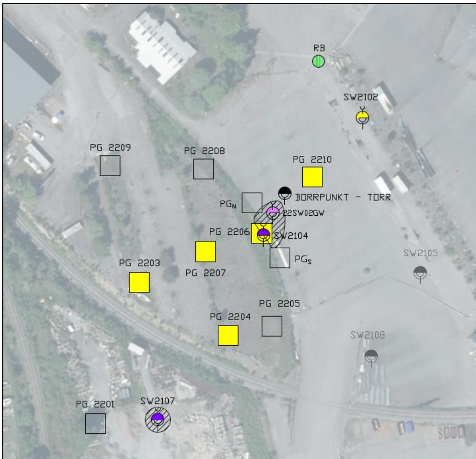
Figur 5. Placering av provpunkter och ungefärlig avgränsning av vattenmagasin med partikelbundet dioxin (streckat område). Källa: Sweco (2023)
