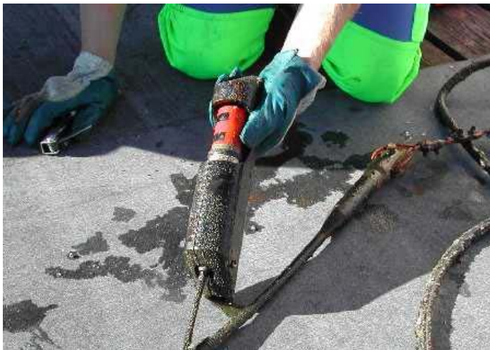
Mätsensor för kontroll av temperatur och turbiditet.
