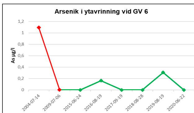
Diagram 7. Arsenik i ytavrinning vid GV 6. Röd linje markerar resultat under Huvudstudie och Referensundersökningar, grön linje är resultat under Efterkontrollen.
