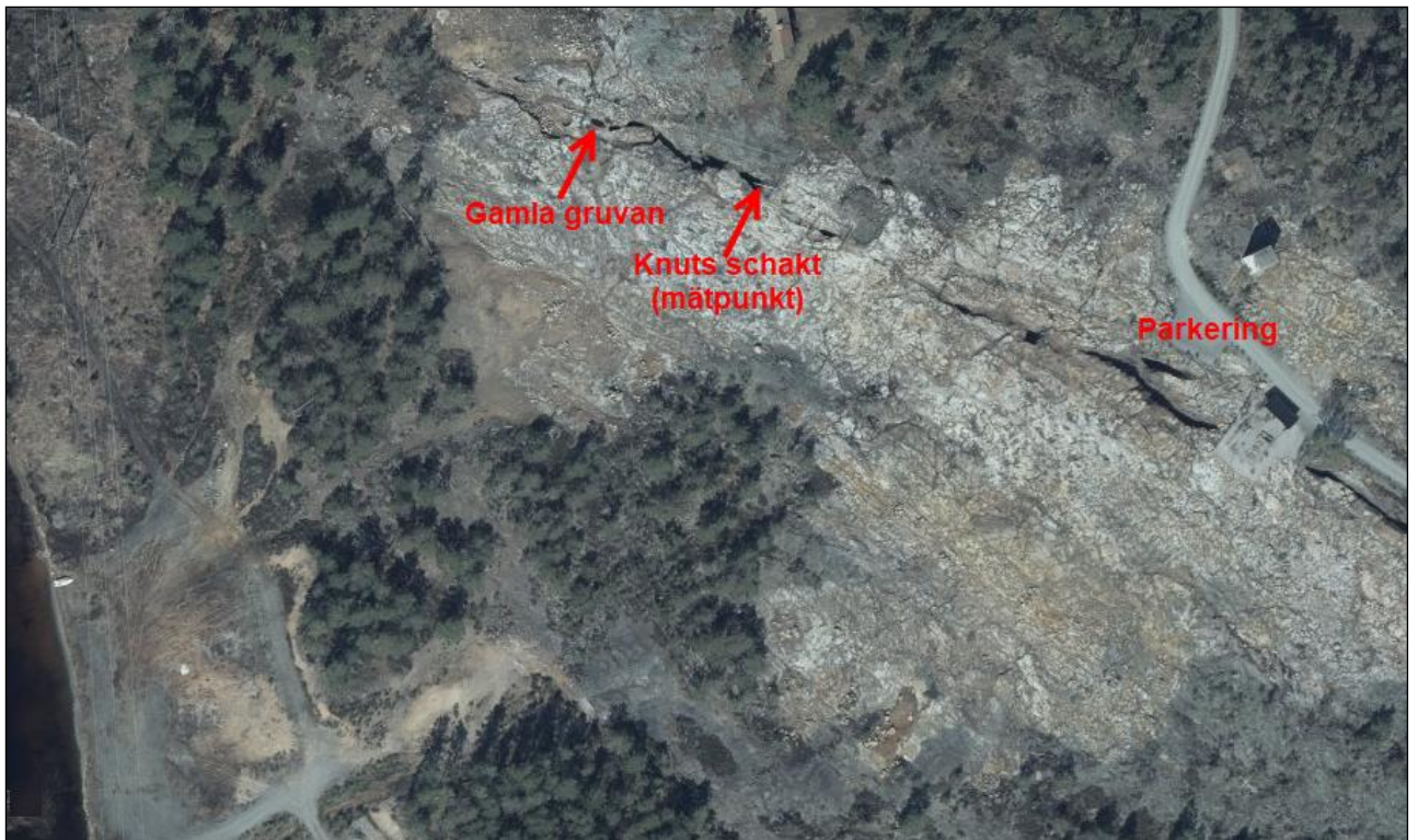
Bild 3. Provpunkt för mätning av gruvvattennivån i Knuts schakt samt Gamla gruvan.
