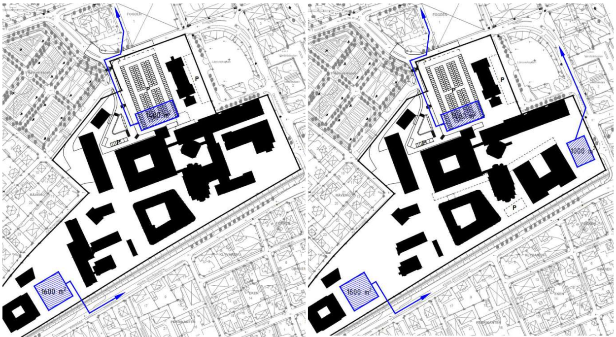
Figur 20, 21: Förslag på placering av dagvattenanläggningar under etapp 5 resp. etapp 7 enligt Lokalstrategiplanen LOST
