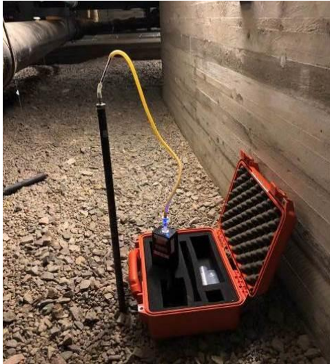
Porgasmätning vid K (underkulvert)
