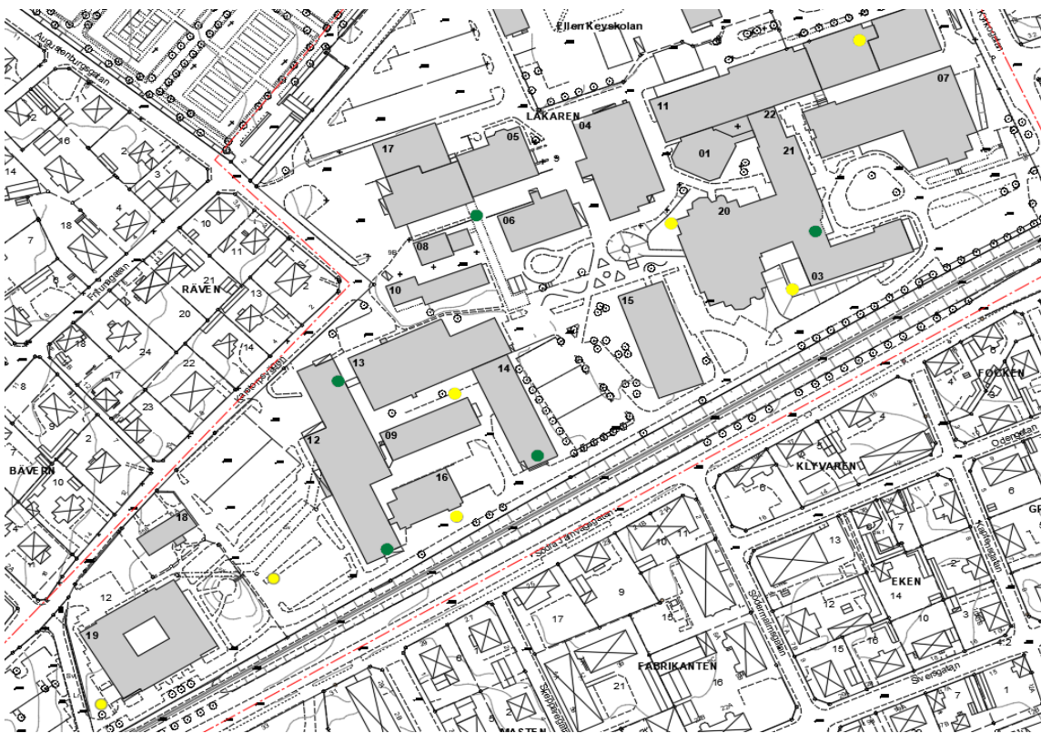
Figur 19: Kloroform i markgas. Grön markering är värde under detektionsgränsen och gul markering är låga värden över detektionsgränsen.
