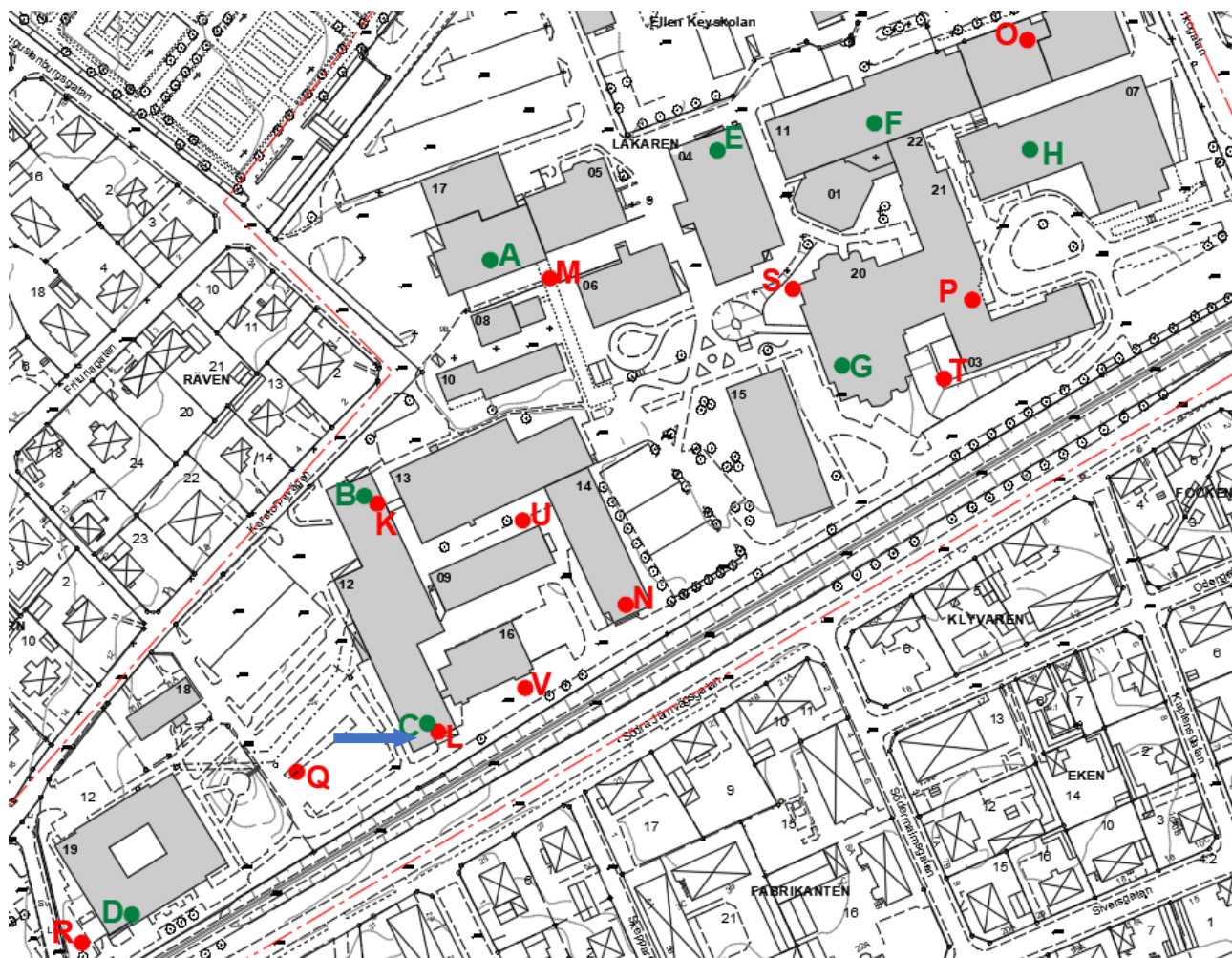
Figur 15: Karta över prov-/mätpunkter; 8 punkter för luftmätning i inomhusmiljöer ( A-H ) och 12 punkter porgasmätning kartläggning av klorerade kolväten i markgas ( K-V). Avvikande mätpunkt L, markerad med blå pil
