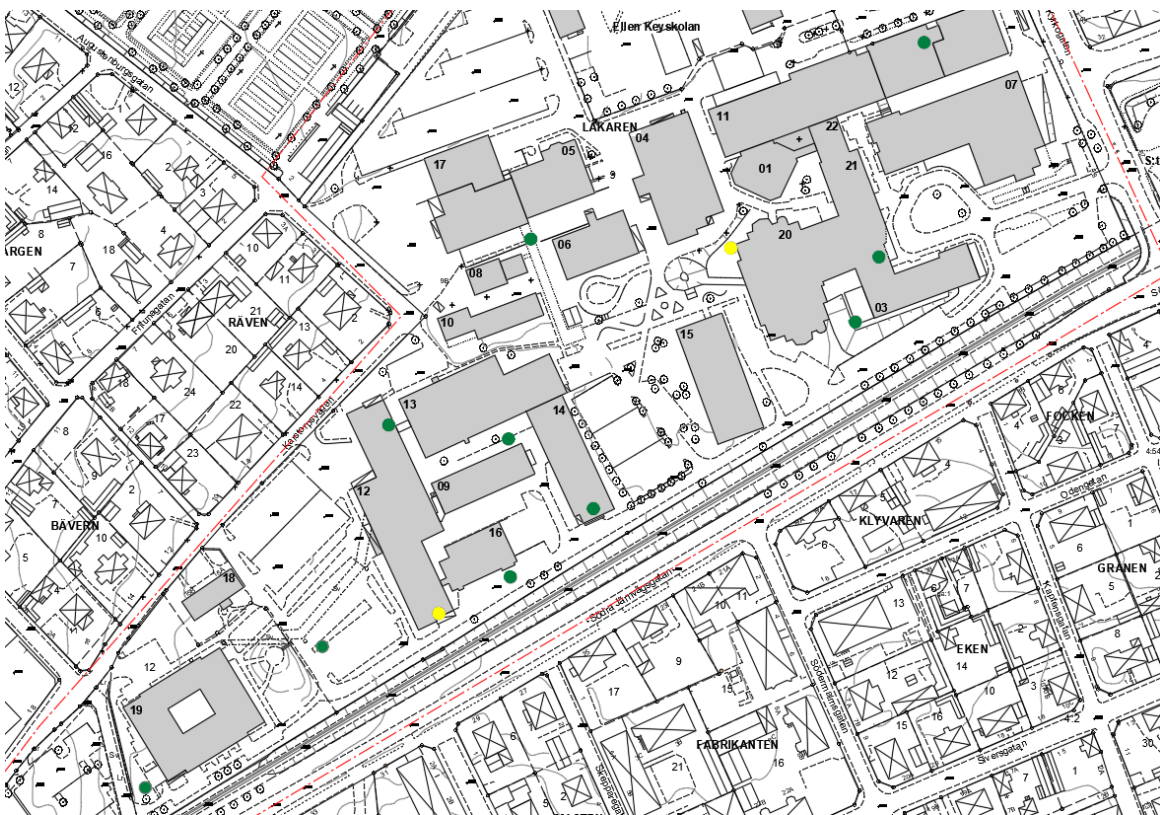
Figur 17: Trikloreten i markgas. Grön markering är värde under detektionsgränsen och gul markering är låga värden över detektionsgränsen.
