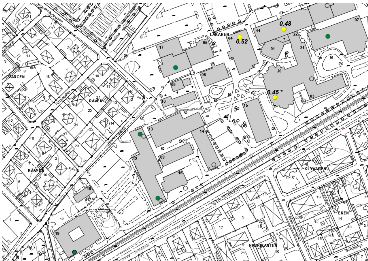
Figur 23: Tetrahalormetan vinylklorid i inomhusluft. Grön markering anger värden under detektionsnivån och gul markering låga värden, strax över detektionsgränsen för analysmetoden.
