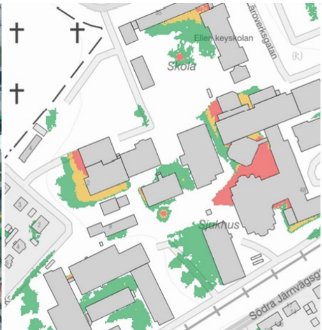
Figur 10 och 11. Datasimulering i program Scalgo. Skyfall 50 mm vattenmängd. Röda områden anger stor risk för översvämning med vattenproblem, gult anger måttlig risk.
