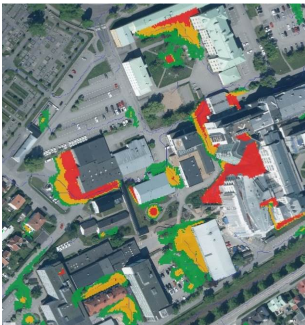
Figur 10 och 11. Datasimulering i program Scalgo. Skyfall 50 mm vattenmängd. Röda områden anger stor risk för översvämning med vattenproblem, gult anger måttlig risk.
