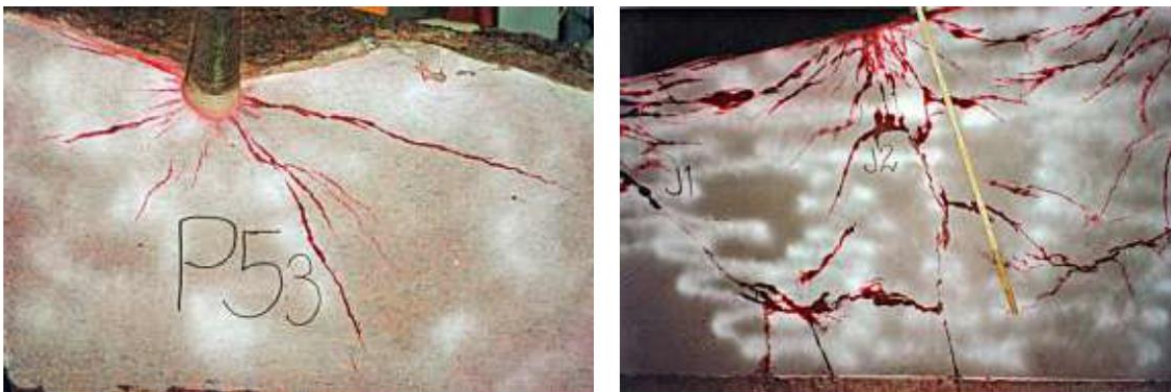
Figur 1: exempel på infärgning av sprickor efter sprängning (från Trafikverkets handbok för ovanjordssprängning, 2014).
