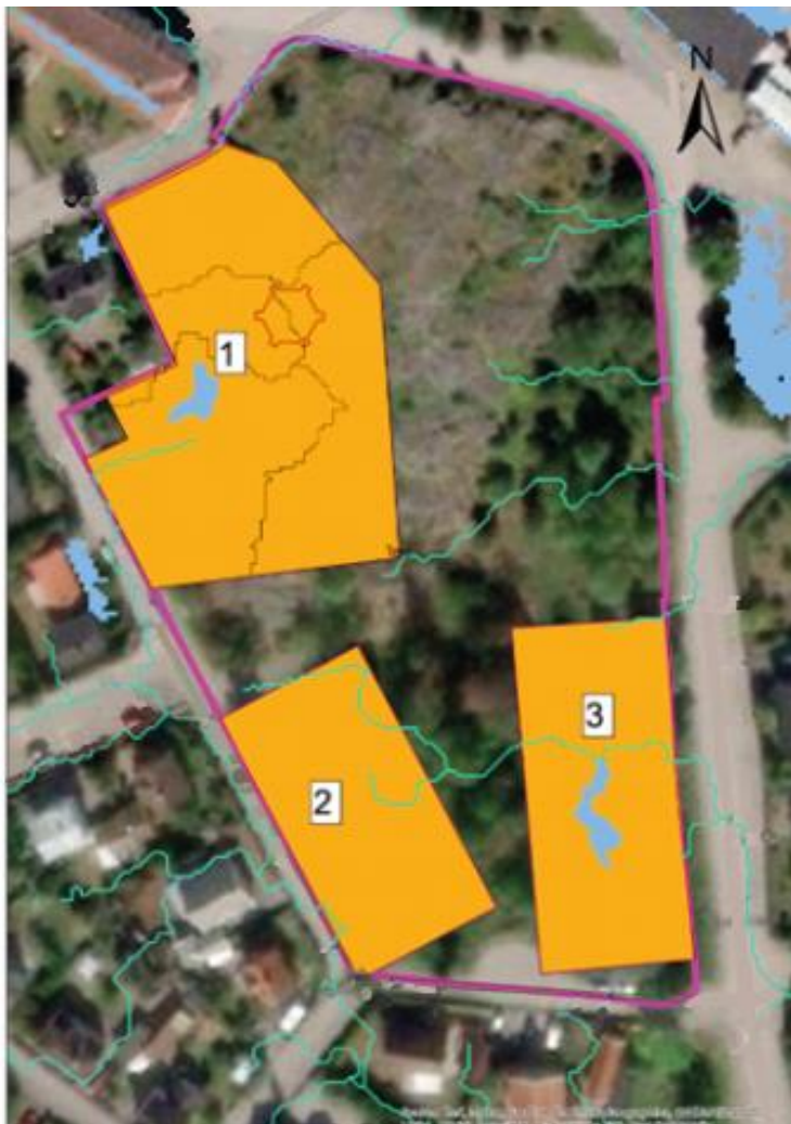
Figur 13. Illustration av sänkor (blått) inom kvarteren (orange) som riskerar att översvämmas vid skyfall. Hämtat från Scalgo Live. © Ortofoto från ArcMap
