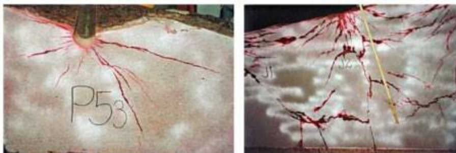
Figur 38: Exempel på infärgning av sprickor efter sprängning (från Trafikverkets handbok för ovanjordssprängning, 2014).
