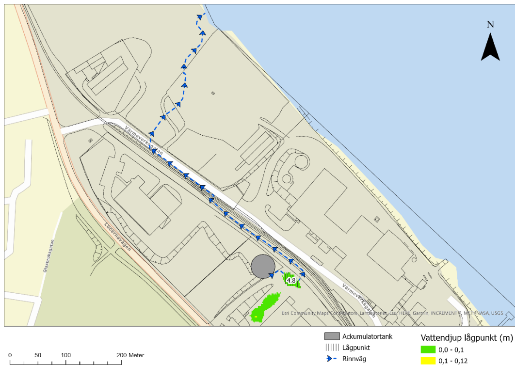
Figur 2. Inzoomad kartbild över rinnväg och lågpunkt från den planerade placeringen av ackumulatortanken. Den skrafferade lågpunkten som rymmer cirka 4,8 m 3 vatten och har ett ungefärligt vattendjup på 0-10 cm.
